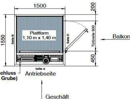
Betonbodenplatte 1600 mm x 1650 mm
